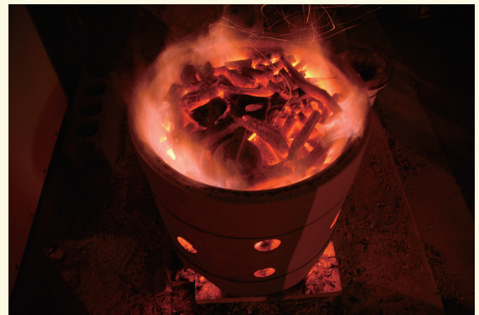
5-3 錦炭窯による焼成実験
