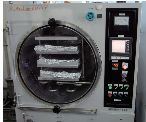
10 稼働中の真空凍結乾燥機 複数の小形木製品を零下 48.5° に凍結中である。
