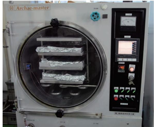
10 稼働中の真空凍結乾燥機
