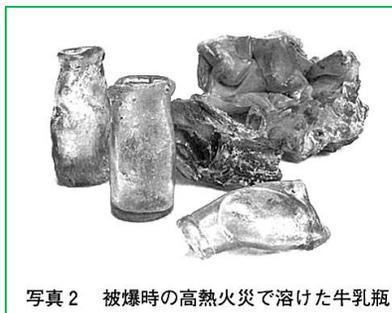
写真2 被爆時の高熱火災で溶けた牛乳瓶
