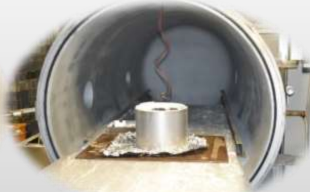
⑥補強後乾燥機搬入
